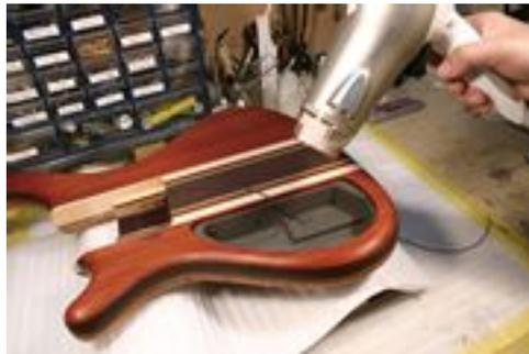
⑤塗装を傷めないように距離を離し、ドライヤーで強制乾燥。
