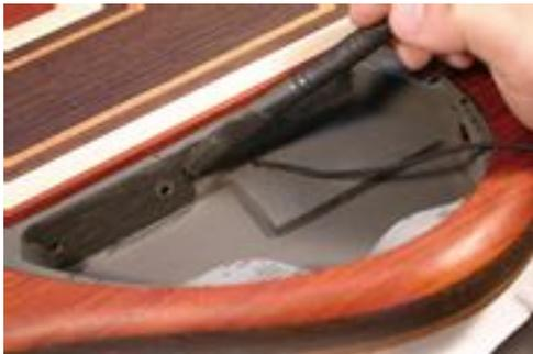
④全面塗布した後に乾燥させ、再度全体に均一に塗布します。
